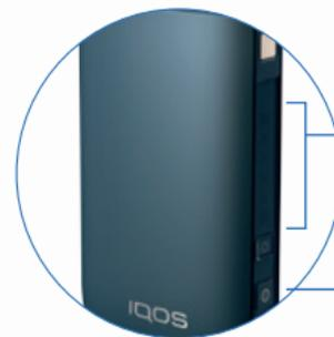
Die LEDs zeigen den Ladestatus des Pocket Chargers und Holders an.
